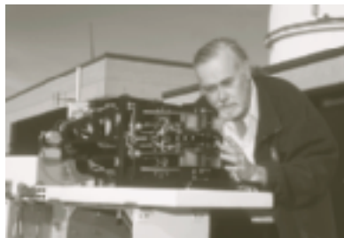
Un spectrophotomètre Brewer de mesure de l'ozone, installé sur le toit de l'observatoire de l'ozone d'Environnement Canada, à Toronto
