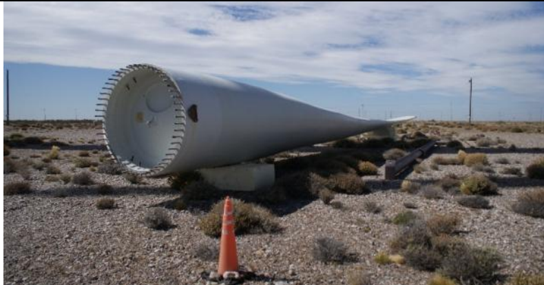
1) Vista de un aspa de aerogenerador.
