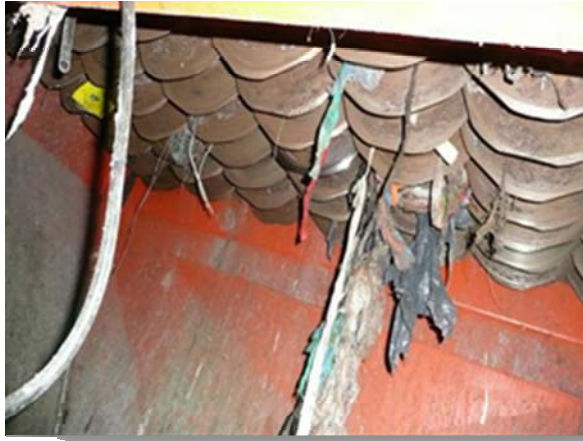
Foto 20. Dispositivo mecánico que rompe las bolsas
