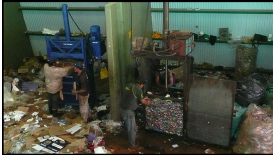
Foto 24. Prensas mecánicas para plástico y cartón
