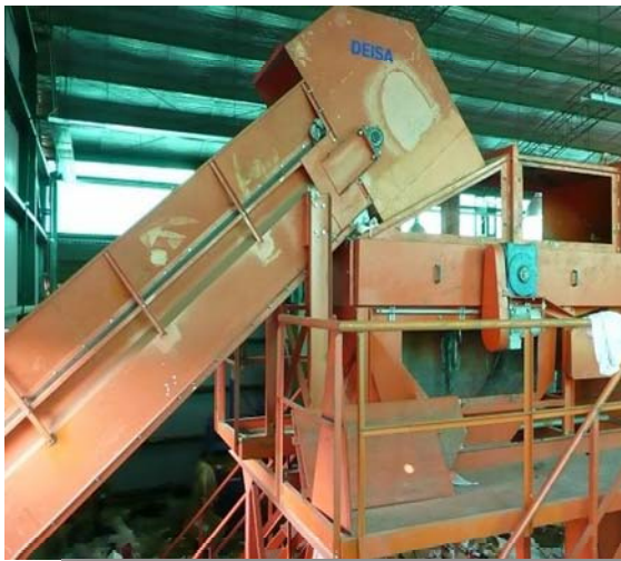
Foto16. Cinta de elevación / alimentación
