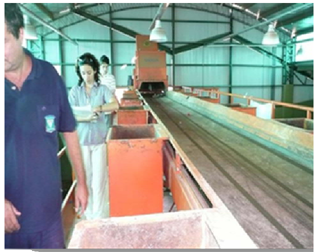
Foto 17. Cinta transportadora de separación de RSU.
